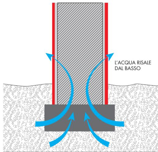
Tutti i materiali da costruzione come intonaci, mattoni, laterizi, e i supporti cementizi in genere presentano una porosità elevata. Questi pori sono comunicanti fra di loro e formano una fitta rete di capillari nella quale l'umidità può risalire dal terreno, lungo le fondamenta dell'edificio non adeguatamente impermeabilizzate.
